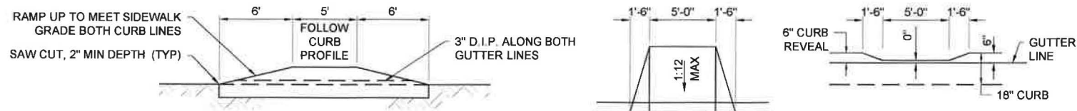
5 SPEED BUMP DETAIL MPT-001 N.T.S.
